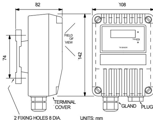
Fig. 8 Dimensions – IR<sup>3</sup> Flame Sensor
